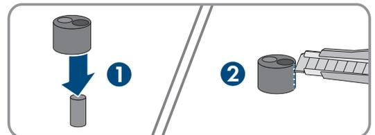
7. Das Batteriekommunikationskabel in eine Kabeldurchführung stecken.
