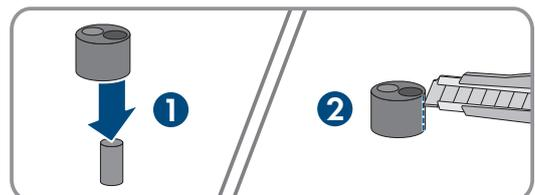
6. Jedes Netzkabel in eine Zweiloch-Kabeltülle stecken.
